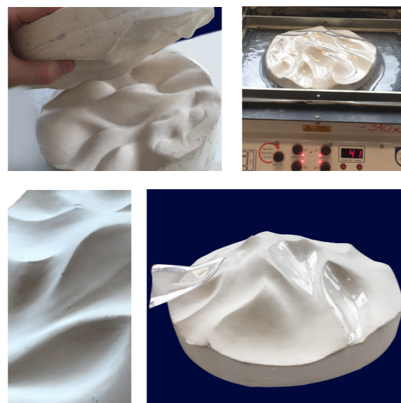
Matrice pour gaufrer le cuir pour la restitution de parties lacunaires d'un galon d'un paravent Louis XIV. Modelage en plastiline du positif d'après photographies, moule à creux perdu en plâtre du négatif, tirage en élastomère du positif, tirage en résine polyuréthane du négatif servant de matrice de gaufrage à la conservatrice-restauratrice Élise Blouet-Ménard.
